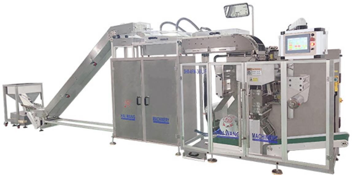
高速自动铝箔包装机具有以下几种特点：1. 成型、热封、压痕、冲截等部件在机身同一平面上可任意调节间距，适应各种尺寸药版的包装，精度高，适用性强。2. 行程可调，自动送料，对版加热，正压成型，上下网纹，气缸热封，自动压痕打批号，机械手牵引，操作简单，运行可靠。3. 采用摆线针轮减速机，噪音低，寿命长。4. 模具压板定位，对版准确，换模方便。5. 组合式机构，拆装方便，便于维修。6、采用国内zui新型的大功率传动机构，由排链带动主传动轴，免除了其它齿轮传动的误差和噪音。7、电器采用进口控制系统，便可按照客户要求，配置缺料漏补装置和缺粒检测剔除装置。8、整机采用分段组合□PVC成形、加料、热封为一段，热带铝冷成形、热封、冲裁为一段可进行分体包装。9、采用光电控制系统□PVC□PTP□硬铝包装自动送料、废边自动冲切装置，确保长距离多工位同步稳定性。10、可另配光电检测校正装置，配进口步进电机牵引，图文对版印刷包装，优化包装物档次。11、本机适用：胶囊、素片、糖衣、胶丸、针剂、异形等以及医疗器、轻化食品、电子元件泡罩密封包装。注：可增配光标对版封合装置、回收废料装置，分裂线装置及导轨等。
