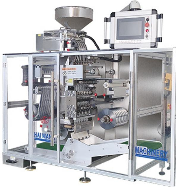
**SHW-APM**高速自动铝箔包装机是我公司研发的新一代软双铝包装设备，该设备设计新颖，结构先进，采用PLC触摸屏控制系统，具有效率高、噪音低、操作简单方便等特点。送料方式采用振动式整列送料机构，并配有光电监测装置，自动控制送料，冲切版数可自由设定，送料、下料、热封、切线、打批号、冲切，计数等工序均自动完成，可达高速运行。适用于制药与保健品行业的各种片剂、胶囊以及电子行业的各种类似片剂状的电子元器件物品的软双铝包装，可达到良好的密封与避光作用，延长了产品的保质期，并携带方便。海王机械为您提供性价比高的铝箔包装机。浙江耐用性高高速自动铝箔包装机销售厂
