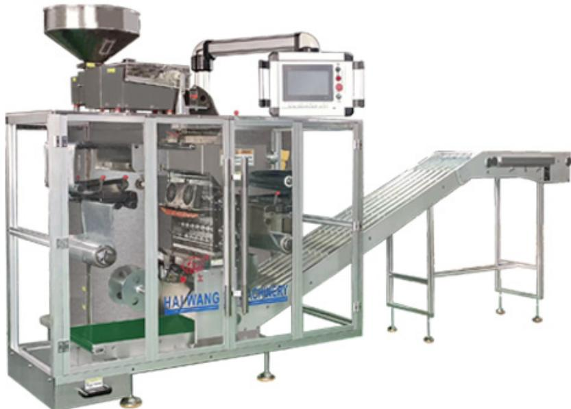
SHW-APM系列高速自动铝箔包装机是高科技含量的包装设备，产品已通过省级科技成果鉴定。机器冲裁频率高，生产能力大，为制药行业药品的规模包装，提高工效降低成本提供了新的选择。PLC编程控制，无级变频调速，人机界面操作，自动化程度高。平板式对版正压成型，成型温度低，节能明显。持续滚筒式网纹切线热封，提高了热封速度。横向无边冲裁结构，较大节约包材，通过可换档齿轮变速器来改变成型次数和冲裁次数的比率，达到满足各种规格药版的生产要求。浙江耐用性高高速自动铝箔包装机销售厂高速自动铝箔包装机厂家批发、促销价格、产地货源，海王为您提供。
